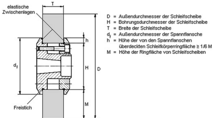
Bild 2: Ringflächenhöhe h von Spannflanschen bei Schleifscheiben H > 0,2 D
